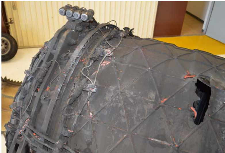
Fig-7. Hole in top of fan case (Tab S-4)
